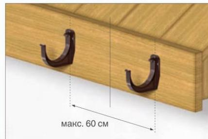
1 На торцевой доске обозначить положение сливной воронки. С обеих сторон воронки, на расстоянии 15 см от края воронки, монтируются держатели желоба.
