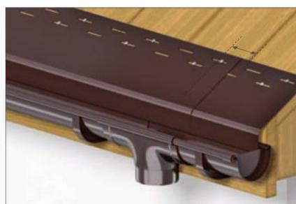
**17** Карнизную планку прибить к доске карниза. Гвозди вбивать в отверстия перфорации в фартуке. Между шляпкой гвоздя и фартуком оставить зазор около 1 мм. Карнизные планки соединять внахлест шириной около 8 см.
