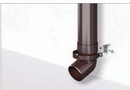
**16** Установить колено как выходное отверстие водосточной трубы. На фасонной части смонтировать хомут трубы с крюком хомута.
