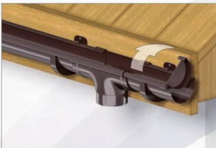
**10b** Универсальная заглушка подходит к левому и правому концам желоба. Передний фланец заглушки вставить в передний фланец желоба и повернуть заглушку вглубь желоба до защелкивания на заднем фланце желоба.
