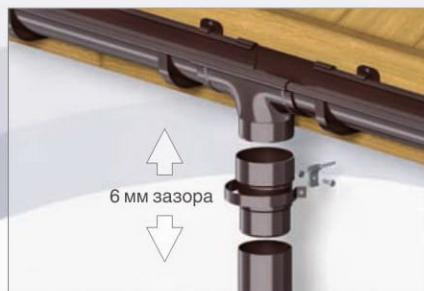
**11** Установить водосточную трубу, соединяя ее со сливной воронкой при помощи соединителя трубы. Хомуты труб крепить на сужении соединителя трубы, к стенам при помощи крюков хомута с шурупом. Расстановка креплений: трубы крепятся к стене здания каждые 2 метра.
