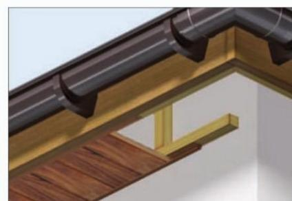
**18** Монтаж подшивки карниза (софита) выполняется при помощи планок типа J, прибитых гвоздями к балкам или обрешетке наaves кровли (макс. каждые 40 см). Панель подшивки вставить в планку типа J. Панели подшивки соединять между собой в замок и крепить через каждые 30 см.
