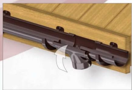
7 Установить сливную воронку. Задний край воронки заложить на задний фланец желоба. Повернуть воронку вперед до защелкивания переднего фланца на торцевом фланце желоба. Длину напуска желоба в воронке подобрать соответственно метке на фасонной части.
