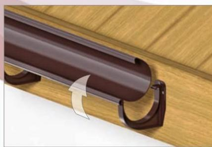
5 Установить желоб в держателях желоба. Вставить передний выступ держателя в передний фланец желоба и повернуть желоб назад до его защелкивания на заднем выступе держателя.
