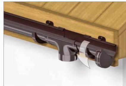
**10a** Установить правые и левые заглушки. Заглушку устанавливать следующим образом: передний фланец заглушки вставить в передний фланец желоба, а затем повернуть заглушку вверх до защелкивания на заднем фланце желоба.
