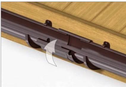
**8** Соединить отрезки желоба при помощи муфты желоба. Длину напуска желоба в муфте выполнить соответственно метке на муфте. Расстояние держателя желоба от края муфты не должно превышать 15 см.
