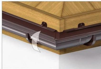
**9** Установить углы на желобе. Вставить задний фланец желоба в задний фланец угла и защелкнуть передний фланец желоба в торцевом фланце угла.
