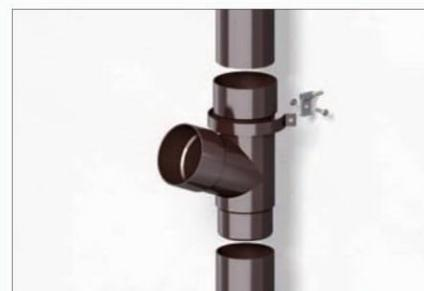
**15** Монтируя тройник или ревизию, необходимо крепить их на стене здания при помощи хомута трубы с крюком хомута. Хомут монтиро вать на фасонной части. Обеспечить около 6 мм зазора в соединении.
