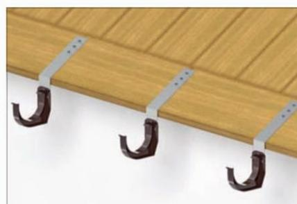
3b Существует возможность выполнения креплений непосредственно на стропильной ноге или доске свеса. Для этого держатели желоба следует привинтить к крепёжной планке, изогнутой соответственно уклону кровли. Расстояние между планками не должно превышать 60 см. (Уклон желоба 0,3%).
