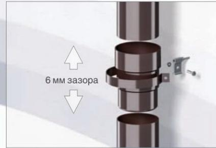
**12** Отрезки труб соединять между собой при помощи соединителя трубы. Хомуты крепить на сужении соединителя трубы. Оставить около 6 мм зазора в соединении водосточная труба – соединитель трубы.
