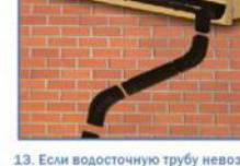
13. Если водосточную трубу невозможно смонтировать непосредственно под сливной воронкой (например, при выступающем навесе), то соединение следует выполнить при помощи двух колен и отрезка водосточной трубы.
