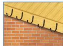
3. Установить держатели желоба, расположенные в наиболее удаленном положении от сливной воронки. Выставить уголок желоба в направлении воронки 0,3% (3 см на 10м). На торцевой или стропильной доске, установить промежуточные кронштейны желоба. Расстояние между кронштейнами должно быть 50 см. На лобовой доске монтируются короткие кронштейны, а на стропильной доске (ноге) длинные кронштейны.
