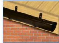
11. Установить заглушки желоба. Заглушку устанавливать следующим образом: задний фланец заглушки вставить в задний фланец желоба, а затем повернуть заглушку до защелкивания на переднем фланце желоба. После окончания монтажа, место соединения обработать силиконом. Заглушка желоба является универсальной и подходит к левому и правому концам желоба.
