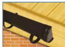
5. Установить желоб в кронштейнах желоба. Вставить задний фланец желоба в задний выступ кронштейна и повернуть желоб вниз до его защелкивания передним фланцем желоба в передних выступах кронштейнах, необходимо без особого усилия сдвинуть желоб и аккуратно завести в передний край кронштейна, исключая царапание желоба. Рекомендуется разместить желоб относительно уклона кровельной плоскости и положения краев кровли на расстоянии  $\frac{1}{4}$  диаметра желоба от края кровли.
