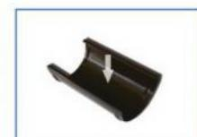
7. Края желобов рекомендовано выставлять в центре соединителя на расстояние 2-3мм друг от друга. Этот зазор заполнить силиконом после монтажа. В случае выставления желобов на большем расстоянии (не более 60мм) друг от друга, края желобов обработать силиконом. Для увеличения герметичности соединения, необходимо заполнить рёбра в фасонных элементах водо и термо стойким силиконом. Высота заполнения силиконом 0,5-1мм от внутренней поверхности элемента.
