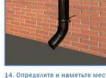
14. Определите и наметьте место расположения отвода. Установите половину держателя в стену. Край отвода после установки должен находиться на расстоянии 200-300 мм от земли. Отвод крепится держателем трубы в специально определенном месте на ребре жесткости.
