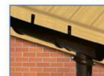
9. В случае монтажа сливной воронки на краю крыши, на воронку устанавливается заглушка воронки. Ребро жесткости на заглушке должно совпадать с ребром на воронке! Установить держатель трубы непосредственно на горловине сливной воронки. При установке заглушек с обеих сторон, сливная воронка может быть использована как отдельный водосборный элемент. После окончательной сборки, места соединений обработать силиконом.
