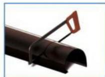
2. Определить необходимое количество желобов и при необходимости отрезать требуемую длину желоба ножковой по металлу с учетом необходимого напуска в фасонной части с обеих сторон желоба, оставив между ними зазор 2-4 мм. Учесть, что при монтаже, желоб заходит в уголок на 90мм, в сливную воронку на 60мм. В соединителях допускается регулировка описанная в п.7.
